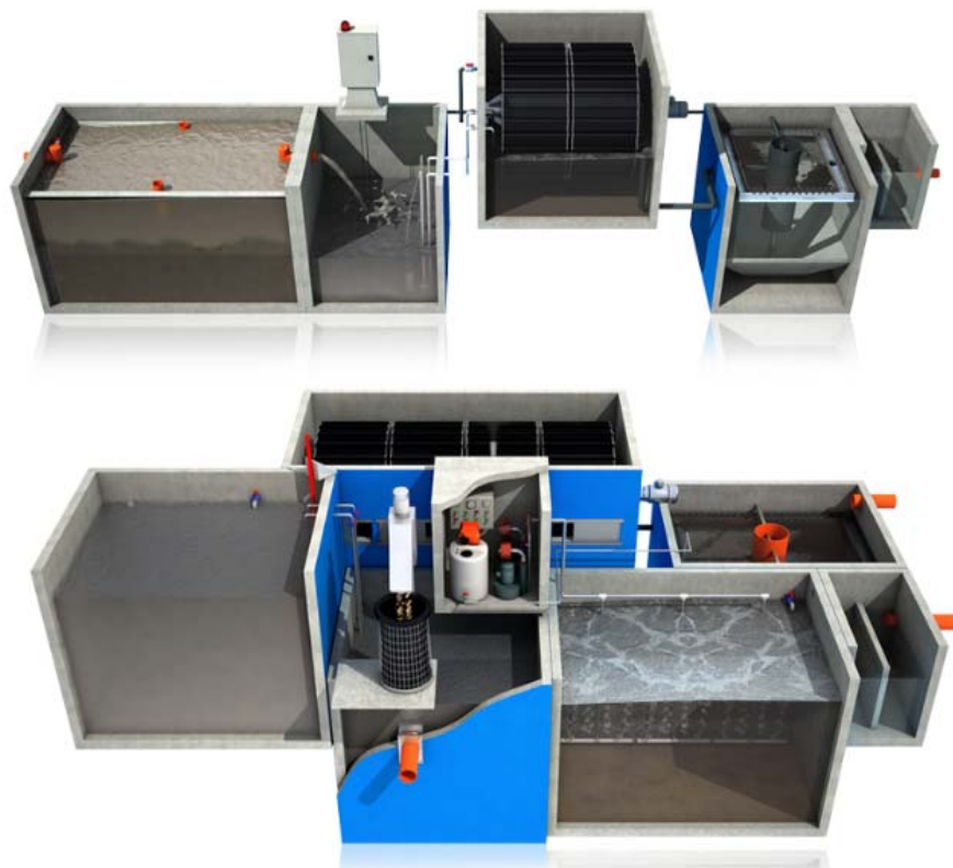
Esempi di Impianti di Depurazione Biologici a Biodischi
