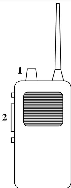
Accendere la radio e regolare il volume tramite la manopola superiore (1)
