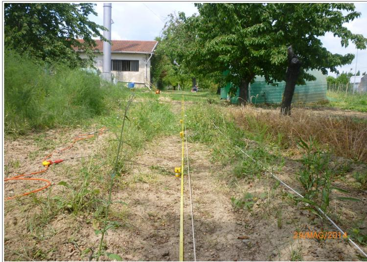
**Foto 2 - Stendimento sismico**
