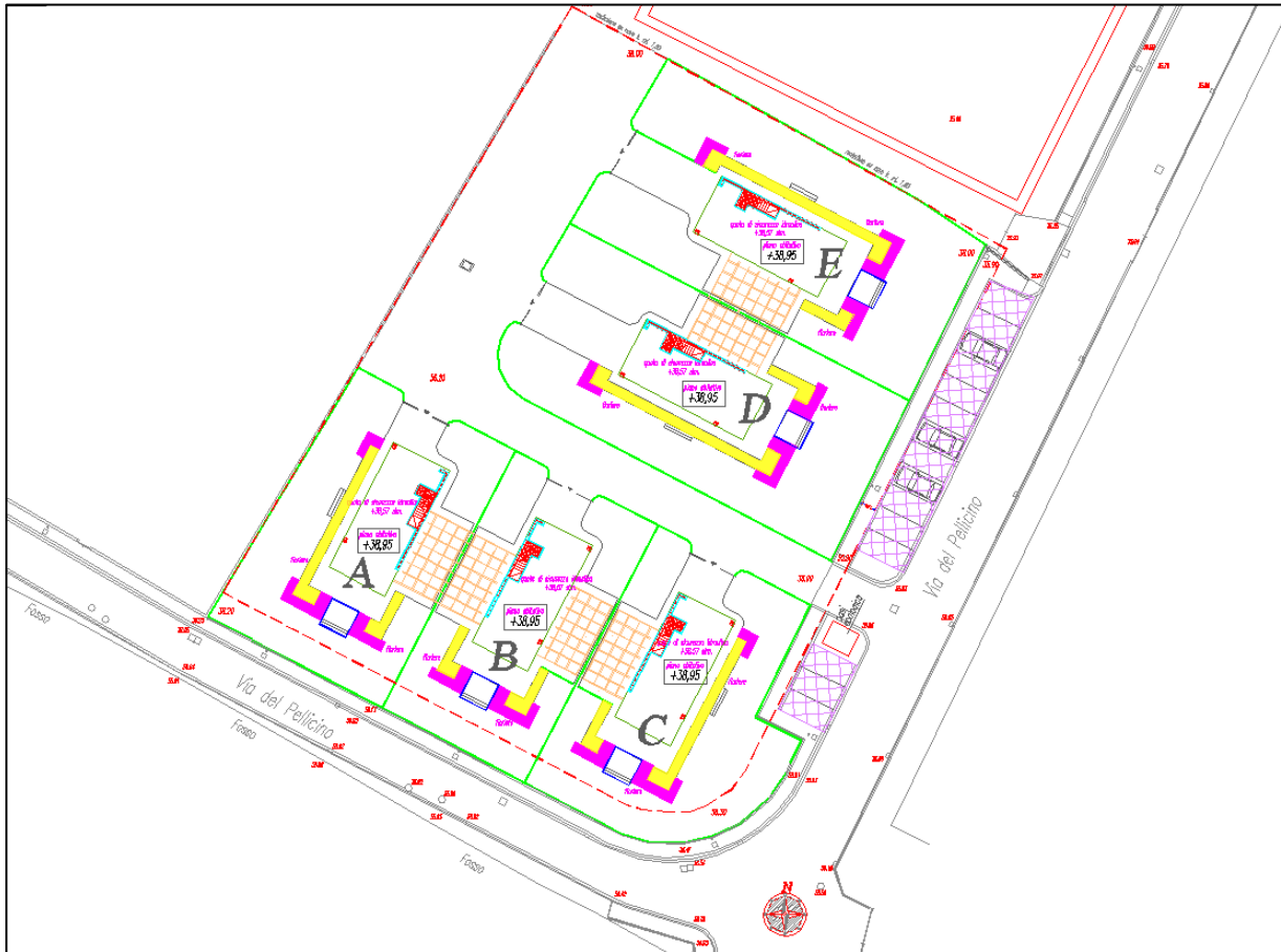
Figura 9 Planimetria di progetto – interventi di messa in sicurezza idraulica e codifica delle aree.
