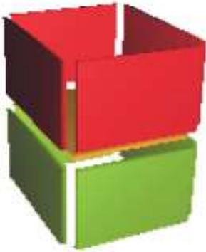
L'isolamento al calpestio esprime la necessità di disaccoppiare le strutture sovrapposte, ma è allo stesso tempo un modo per ridurre le problematiche di trasmissione per via solida fra tutti gli ambienti dell'edificio. Come risulta dalla Tab. A del citato D.P.C.M. 5/12/1997 risulta che l'isolamento al calpestio richiesto debba essere pari ad almeno  $L'_{nw} = 63$  dB per gruppo A-C.
