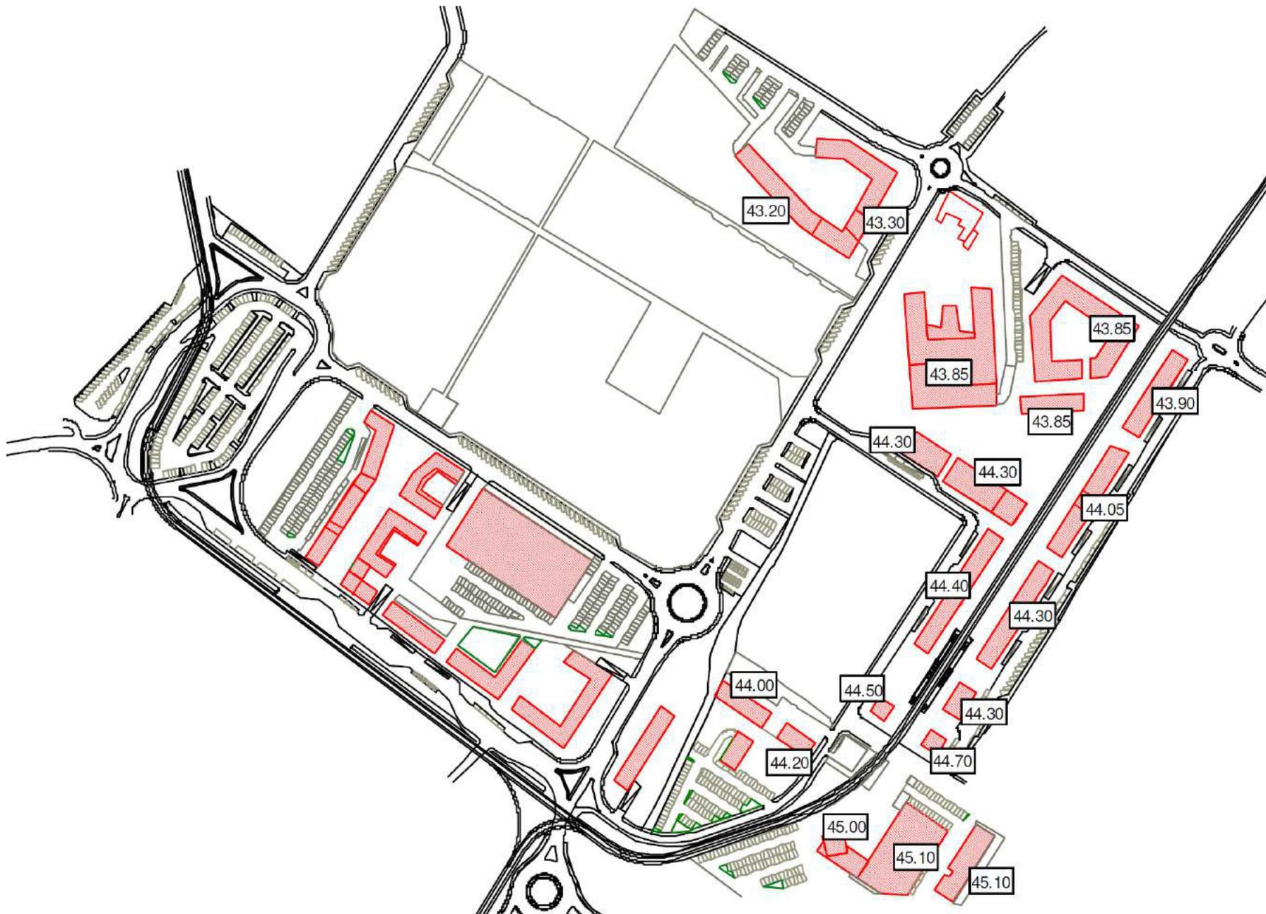
Figura 19 – Estratto della Relazione idrologica e idraulica allegata allo Studio idraulico-idrogeologico a supporto del Piano Particolareggiato dell'area di trasformazione Tr04: Quota di sicurezza (o di sopraelevazione) del piano di calpestio degli edifici in progetto interessati dalle esondazioni duecentennali.
