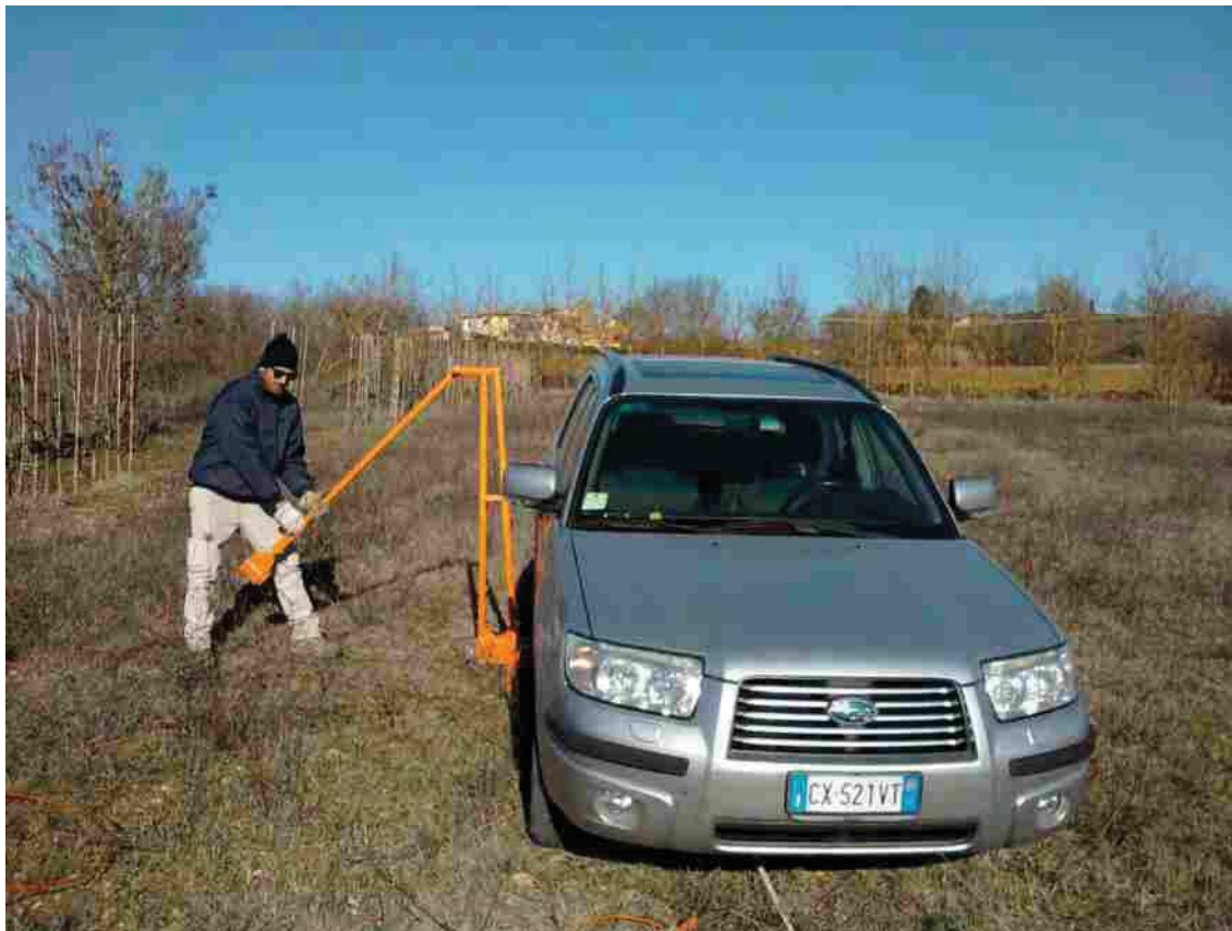
Figura 1: Particolare del tratto centrale della sezione ST9: Shot point C – Onde SH.
