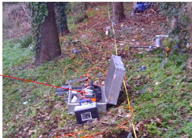
Dato che il caso di un sottosuolo omogeneo può ritenersi solo teorico, i valori di resistività rilevati sono valori di resistività “apparente” ( $\rho_a$ ), influenzati e mediati sull'intero spessore indagato. La resistività apparente si misura in  $\Omega \cdot m$  (Ohm per metro lineare) ed esprime il valore della resistività calcolato con una certa configurazione geometrica ed è dipendente dai valori di resistività dei singoli strati interessati dalla corrente immessa.
