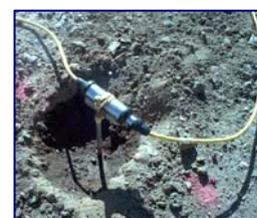
Tramite gli elettrodi **A - B** si immette nel terreno una corrente continua  $I_c$ , mentre tramite gli elettrodi **M-N** viene rilevata la differenza di potenziale  $V$  che si instaura. Conoscendo  $I_c$  e misurando  $V$  si calcola la resistività elettrica relativa alla configurazione elettrodica utilizzata, usando la formula:
