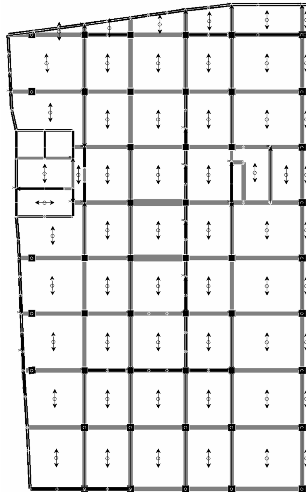
Figura 19 – CARPENTERIA IMPALCATO COMMERCIALE
